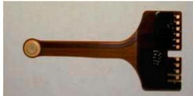
Fig. 1 GASEOUS SE DETECTOR (GSED)
