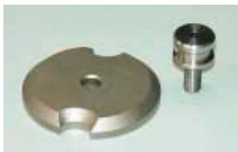
**Fig. 5 STAGE ADAPTER AND SAMPLE MOUNT**
